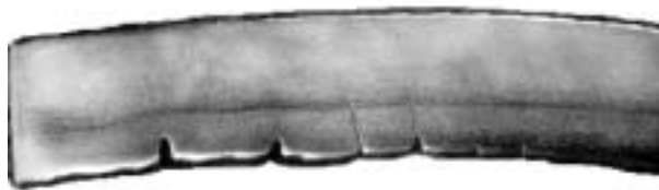
Рисунок 1 - Поперечное сечение образца трубы пиролиза после эксплуатации
