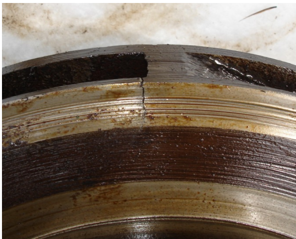
Рисунок 9. Трещина в месте примыкания лопатки к диску рабочего колеса
