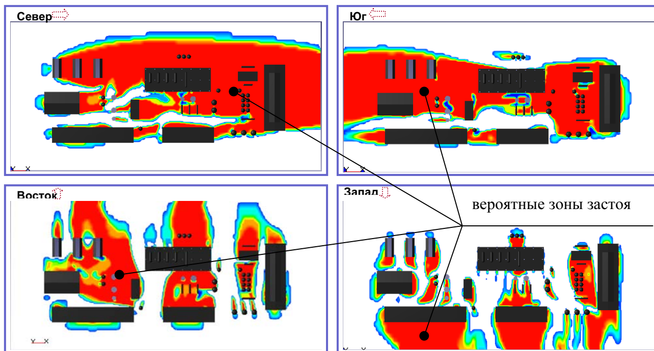
Рисунок 8. Вероятные зоны застоя на отметке H=2 м при силе 2 балла (красный цвет показывает вероятные зоны застоя, градиент от красного к синему отражает зону перехода повышения скорости ветра на данной плоскости)
