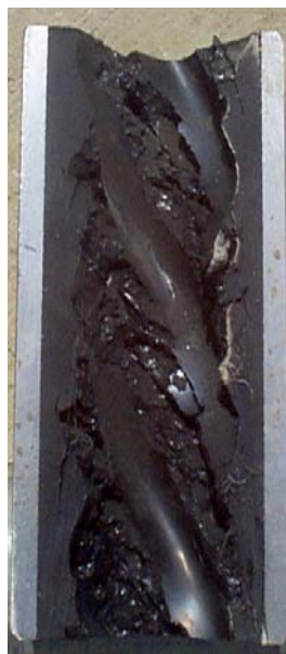
Рисунок 4 - Внешний вид резиновой обоймы, разрушенной вследствие высокого избыточного давления
