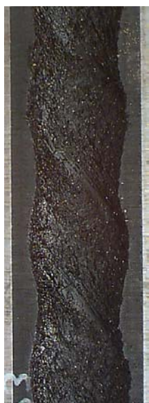
Рисунок 6 – Внешний вид резиновой обоймы, разрушенной вследствие воздействия ароматических соединений
