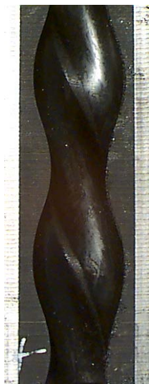
Рисунок 5 – Внешний вид резиновой обоймы, разрушенной вследствие абразивного износа
