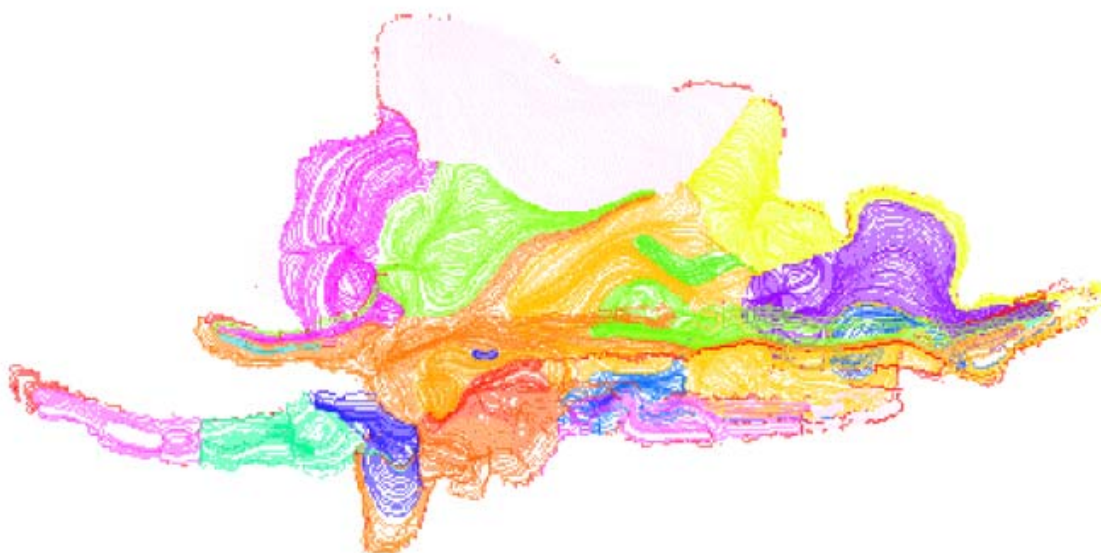
Рис. 2. Пример применения метода линий тока для модели в масштабе всего месторождения (линии тока окрашены в зависимости от нагнетающей скважины), показывающий что выбор «сектора» всегда сложная задача [1]
