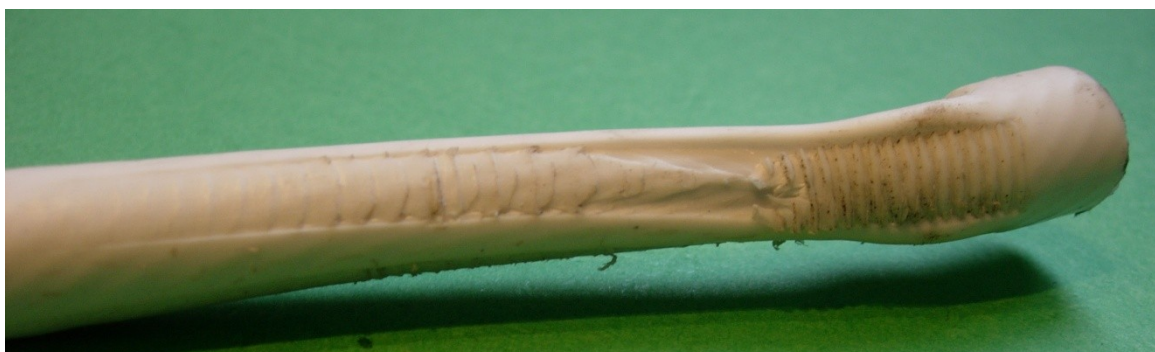
Рис. 8. Повреждение полимерного слоя при осевой нагрузке
