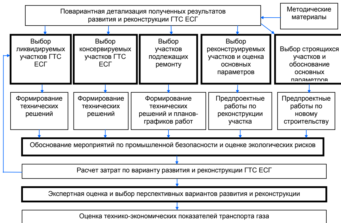
Рисунок 2. Формирование схемы развития и реконструкции на уровне участков ГТС ЕСГ
