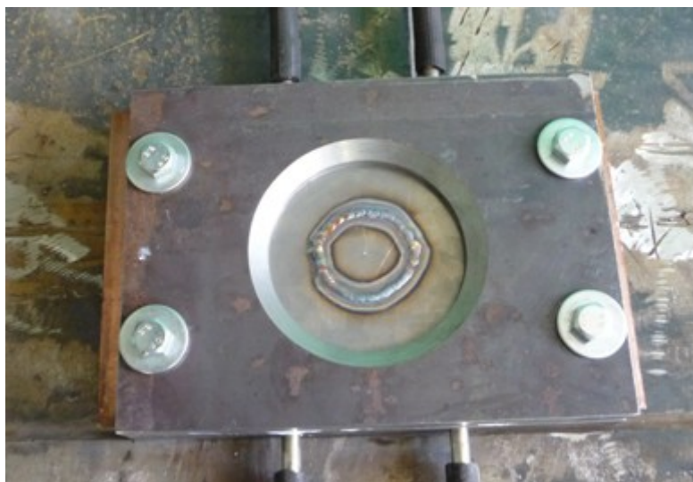
Рисунок 1. Приспособление для технологических испытаний на склонность к образованию ХТ
