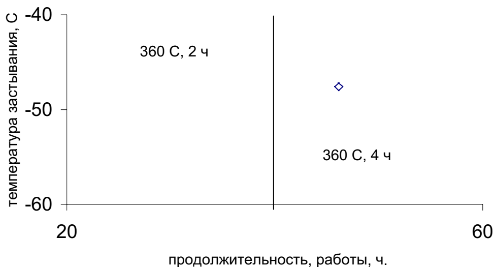
Рис.4. Влияние объемной скорости подачи сырья и продолжительности работы катализатора на температуру застывания дизельного топлива. Катализатор предварительно обработан смесью дисульфидов и анилина
