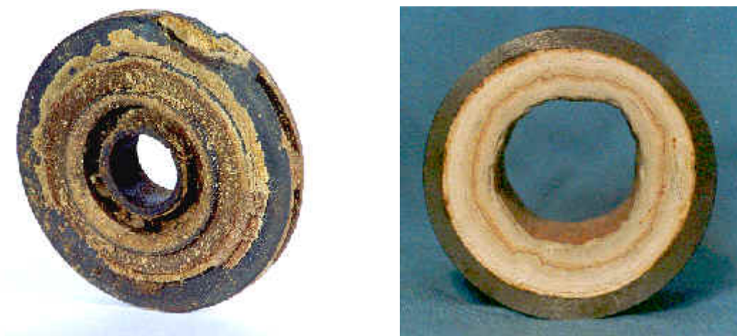
Рис. 1. Отложения солей в рабочем колесе ЭЦН и НКТ
