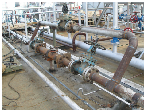
Рисунок 8. Фотография измерительного участка промышленной тестовой установки на морском промысле
