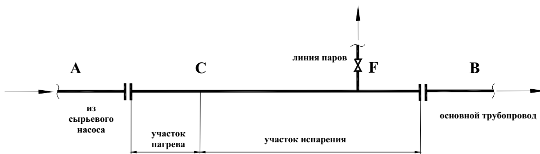
Рисунок 1 - Схема предлагаемой организации потоков в печи
