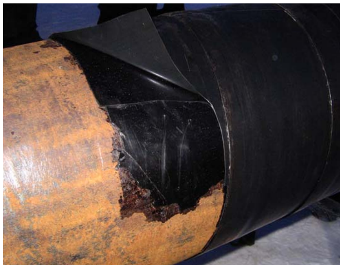
Рисунок 2. При отрыве изоляционного покрытия асмольная мастика остается на поверхности металла (температура минус 25 °С)
