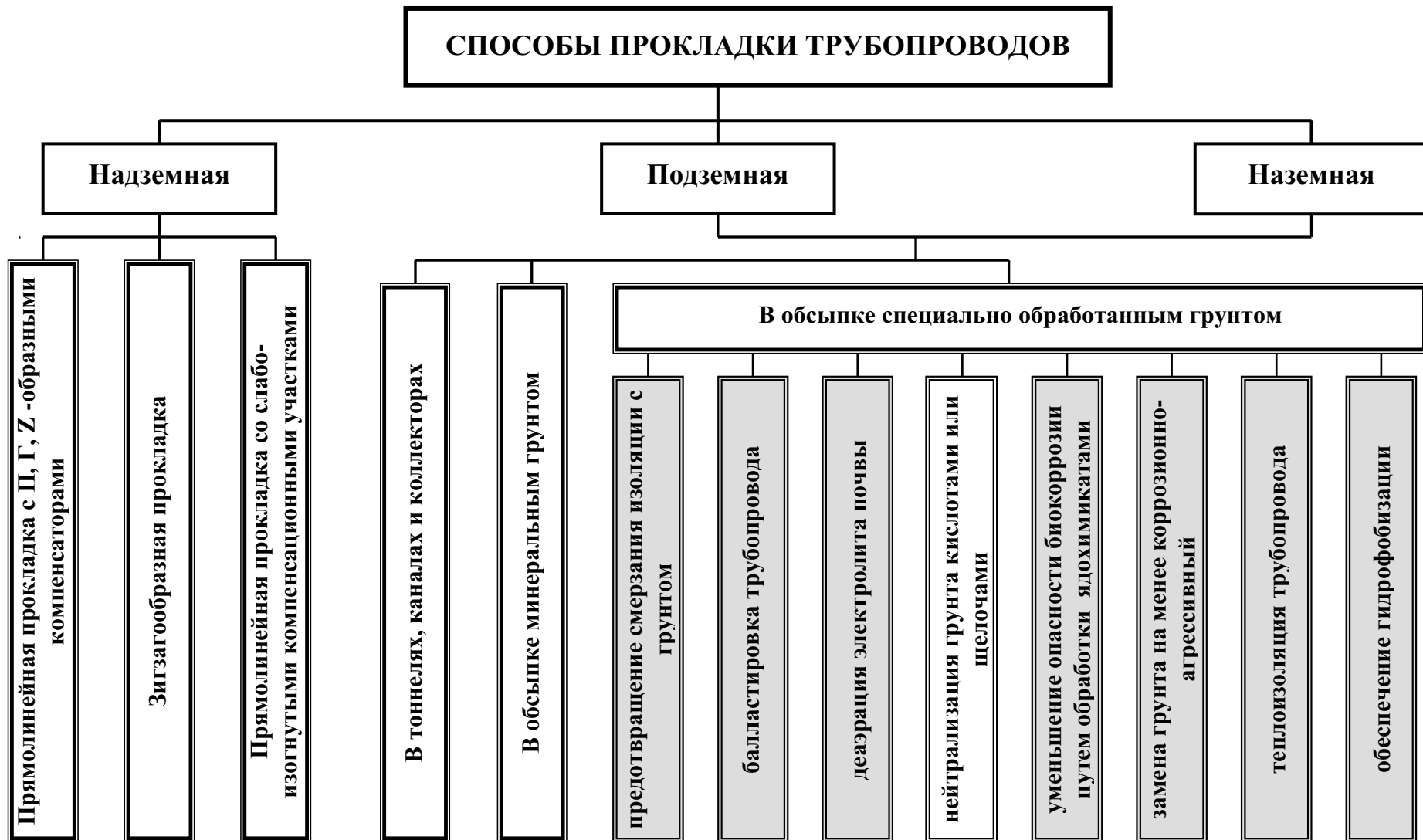
Рис. 1. Классификация способов прокладки трубопроводов:
