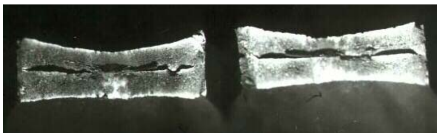
Рисунок 8 - Расслоение металла после испытания образцов на растяжение
