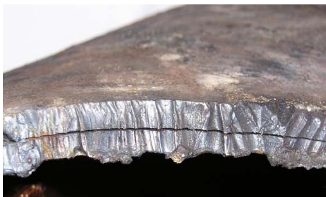
Рисунок 1 - Вид разрушения на 11 км газопровода СРТО - Торжок
