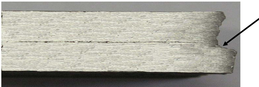
Рисунок 11 – Вид излома образца после проведения малоцикловых усталостных испытаний (стрелкой показано отклонение растущей трещины в зоне ликвационной полосы от магистрального направления)
