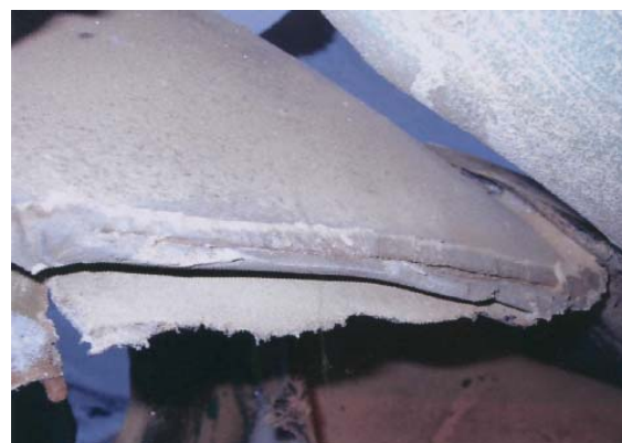
Рисунок 1 - Вид разрушения на 11 км газопровода СРТО - Торжок
