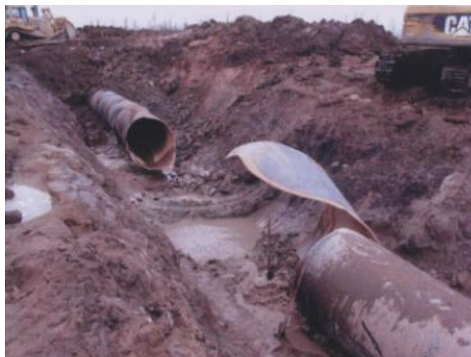
Рисунок 1 - Вид разрушения на 11 км газопровода СРТО - Торжок
