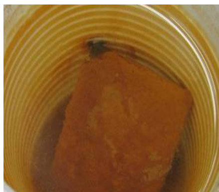
Рис. 4. Фотография стальной пластины в водном растворе ингибитора коррозии марки Нефтехим НС
