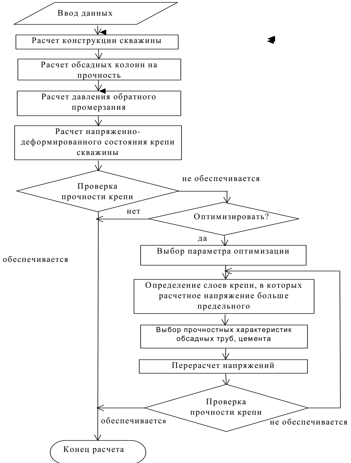
Рисунок 8 – Блок - схема оптимизации крепи скважин в криолитозоне
