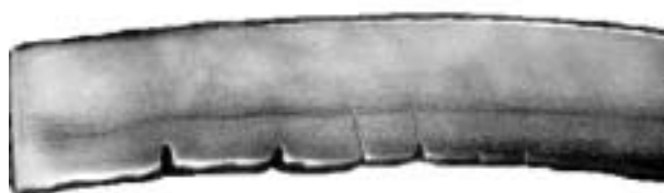
Рисунок 1 - Поперечное сечение образца трубы пиролиза после эксплуатации
