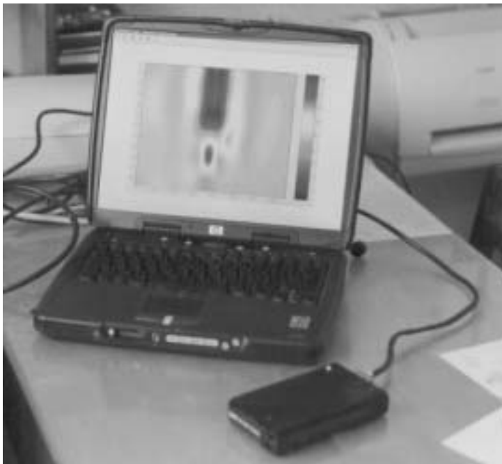
Рис. 12. Электромагнитный интроскоп на базе персонального компьютера типа ноутбук
