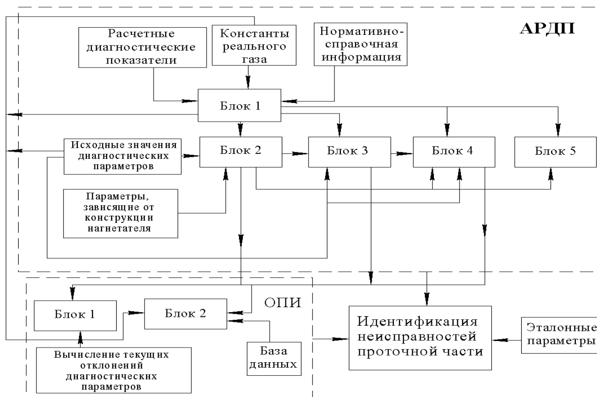
Рис. 2. Принципиальная блок-схема алгоритма диагностирования нагнетателя
