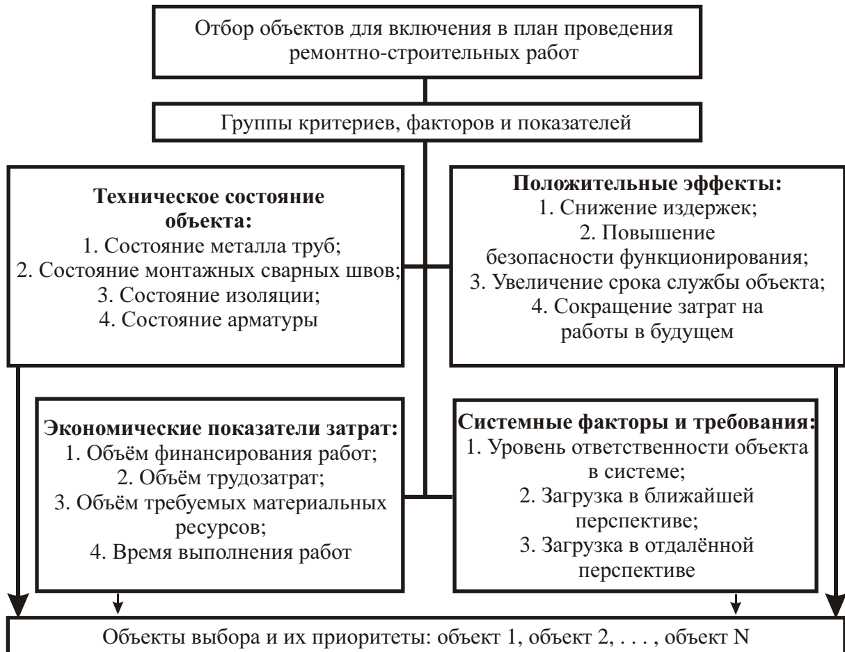
Рис. 1. Схема многокритериального анализа объектов при их отборе для включения в программу проведения ремонтно-строительных работ
