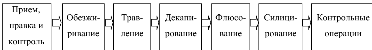
Рис. 10. – Схема технологического процесса силицирования труб
