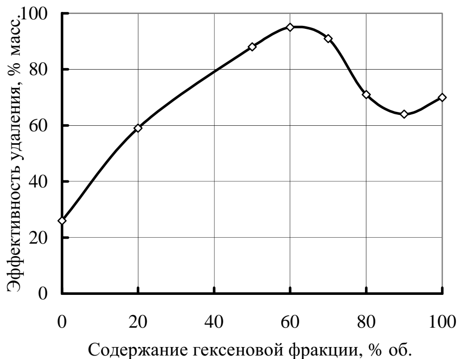
Рисунок 3 - Зависимость эффективности удалителя от содержания гексеновой фракции для отложения Татышлинского месторождения (скважина 4434)
