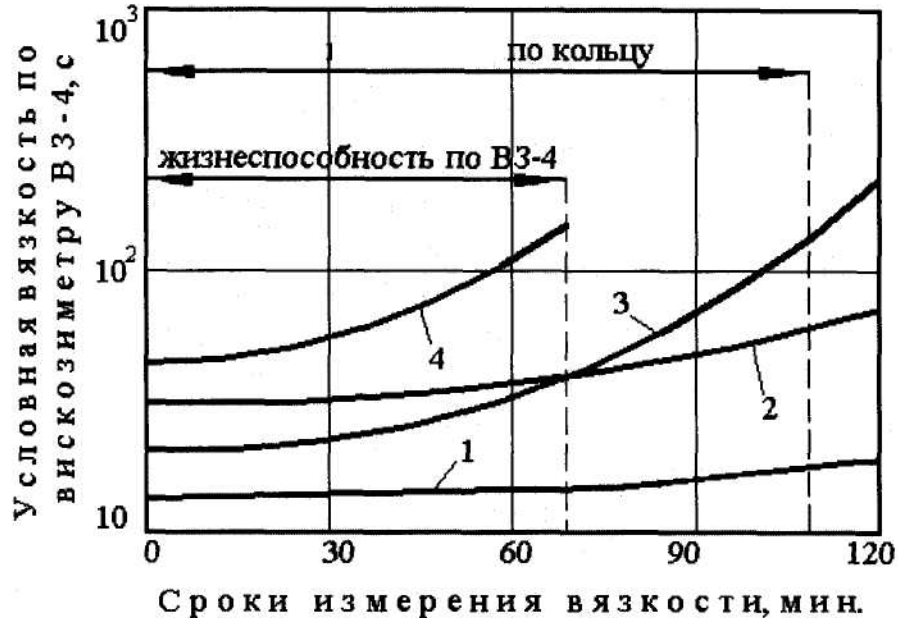
Рис. 1. Вязкость клеящих составов: 1 - латекс без наполнителя; 2 - латекс + 30% мраморной муки; 3 - латекс + 60% жидкого стекла; 4 - латекс с жидким стеклом и мраморной мукой (мас. %): 52: 16: 32
