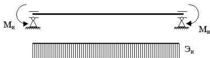
Рисунок 2. Схема нагружения и эпюра изгибающих моментов при чистом изгибе
