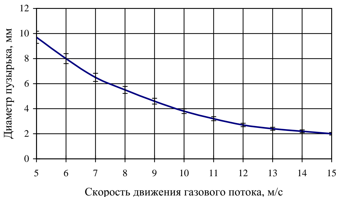
Рис.3 Зависимость диаметра пузырька от скорости движения потока
