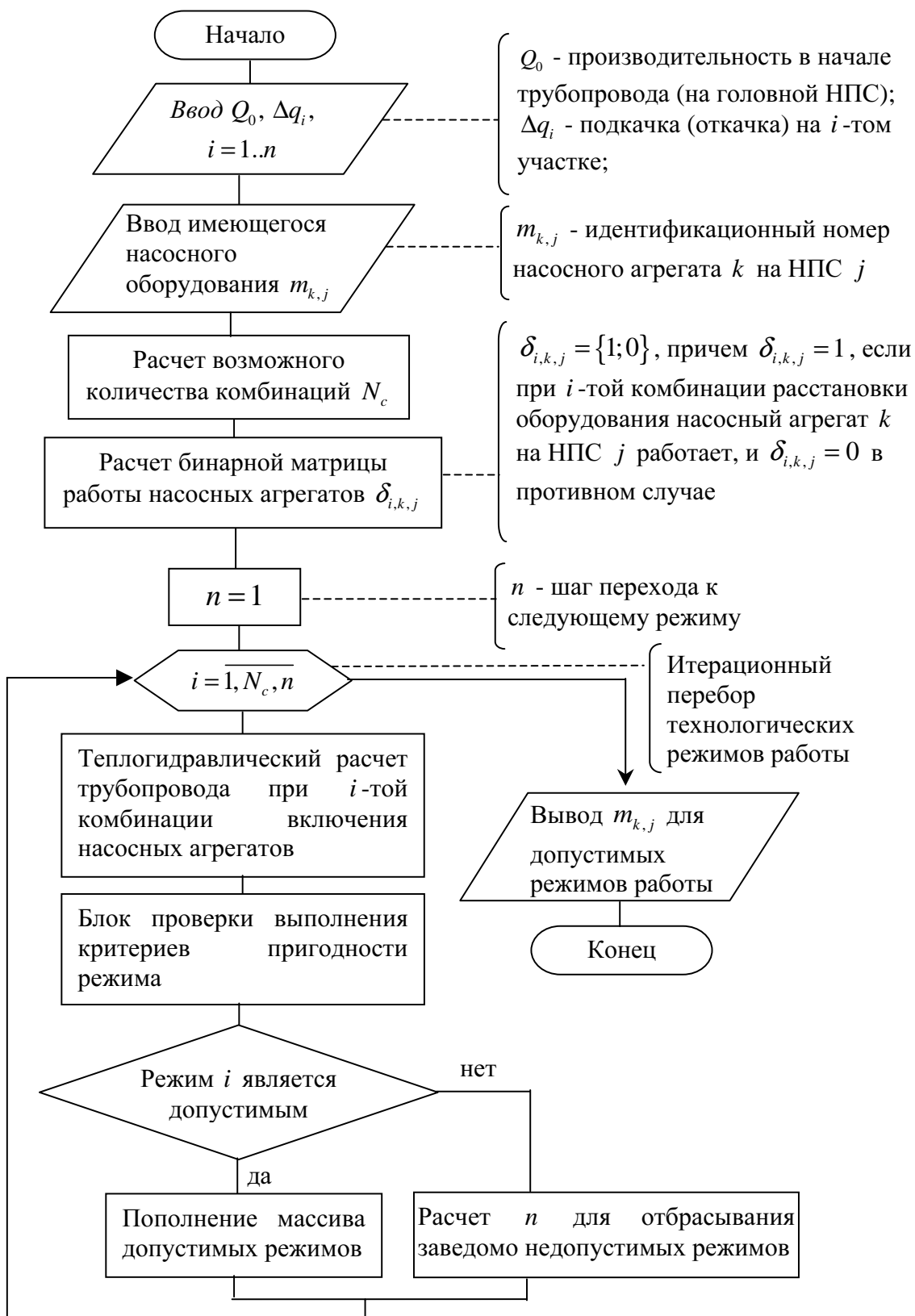
Рисунок 1 - Блок – схема подбора допустимых комбинаций включений насосных агрегатов для обеспечения требуемой производительности
