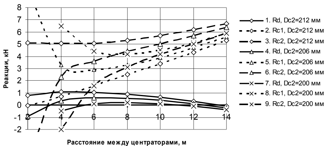
Рисунок 3. Зависимости реакций на долоте и центраторах от геометрических параметров компоновки. Диаметр первого центратора 214 мм; расстояние между ним и долотом 4,64 м; зенитный угол 20°
