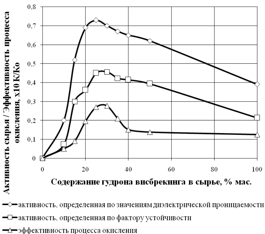
Рис. 4. Зависимости активности смесового сырья и эффективности процесса окисления от содержания остатка висбрекинга в сырье
