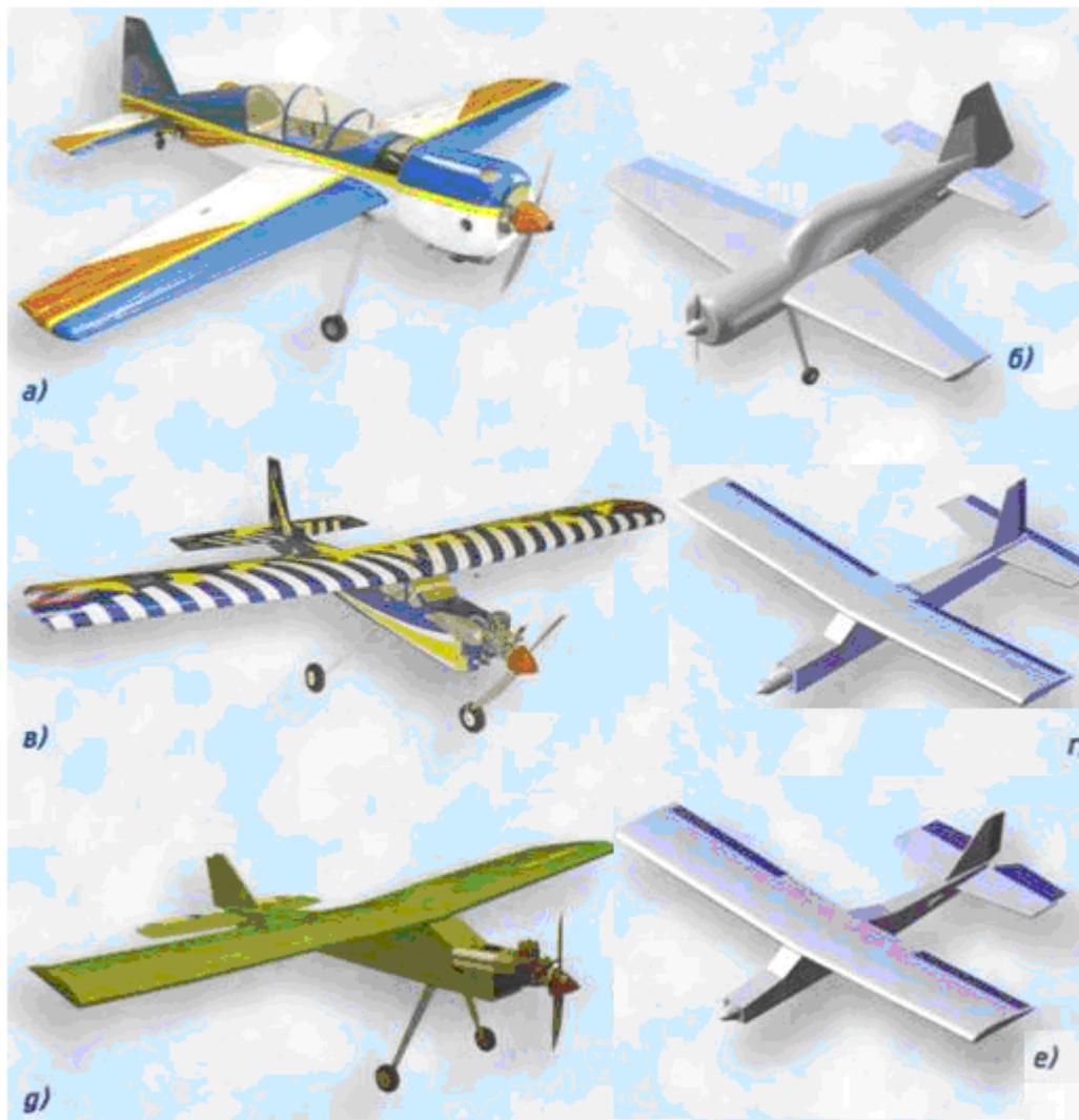
Рис. 4. Беспилотные летательные аппараты (реальные образцы и их 3D - модели): а, б – ЯК-54; в, г – Ripmax; д, е – ENTR40
