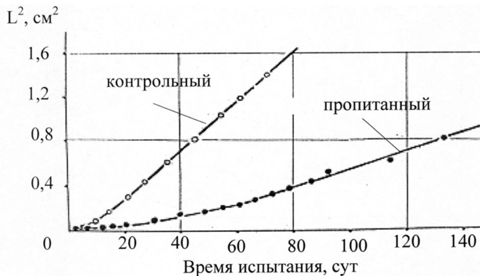
Рис. 6. Кинетика коррозионного поражения пропитанных и непропитанных цементно-песчаных образцов в 0,1%-ном растворе соляной кислоты ( L - глубина коррозионного поражения)
