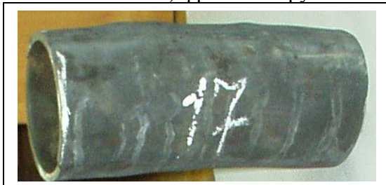
б) необратимая пластическая деформация формы трубы
