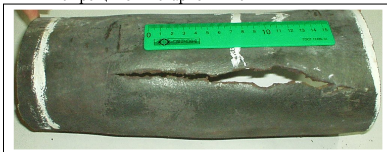
д) пластически деформированная труба с продольной трещиной
