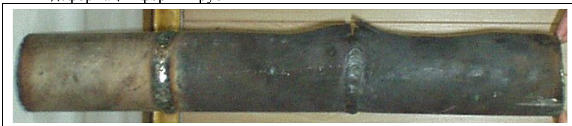
г) пластически деформированная труба с трещиной в сварном шве
