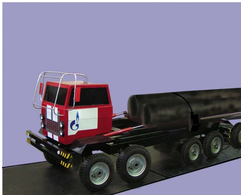
Рисунок 9. Транспортная машина повышенной проходимости для перевозки длинномерных грузов (4х-осная машина)
