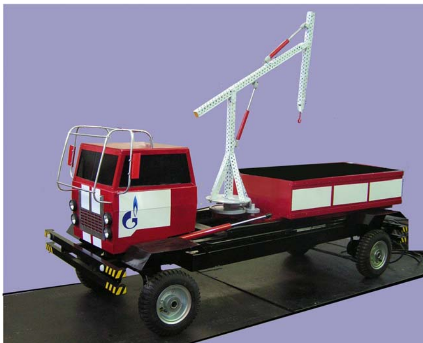
Рисунок 7. Транспортная машина повышенной проходимости для перевозки жидких фаз продуктов (2х-осная машина)
