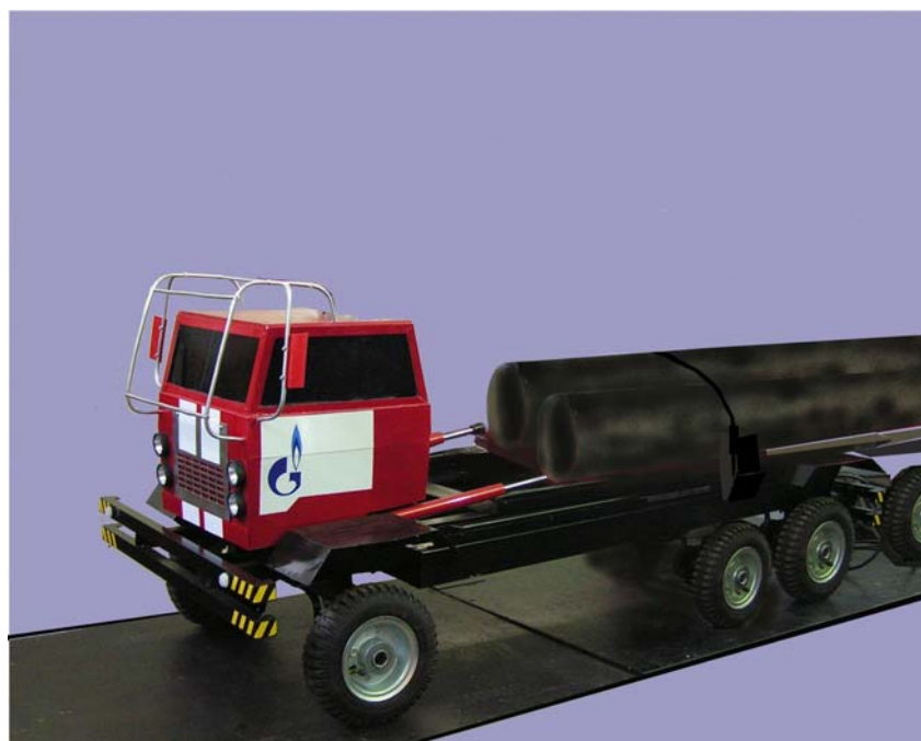
Рисунок 10. Транспортная машина повышенной проходимости для перевозки длинномерных грузов (3х-осная машина)
