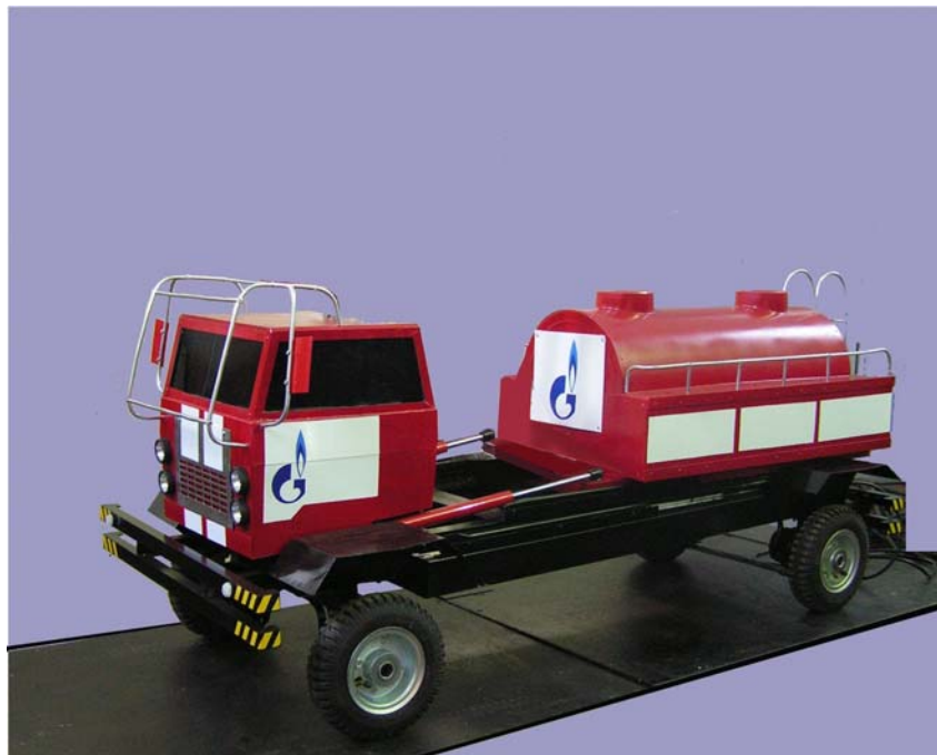
Рисунок 3. Транспортная машина повышенной проходимости для перевозки жидких фаз продуктов (2х осная машина)
