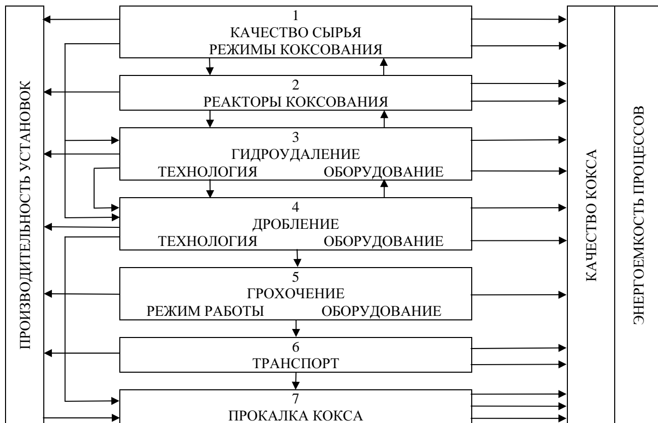
Рис. .3.1. Взаимосвязь механотехнологических параметров производства нефтяного кокса
