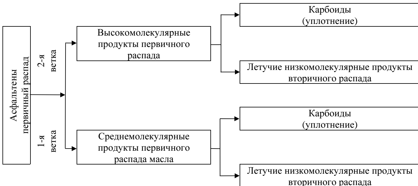
Рис. 5.3. Схема образования карбоидов при разложении асфальтенов по М.Е. Левинтеру
