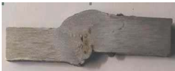
Рисунок 2 - Поры и смещение кромки
