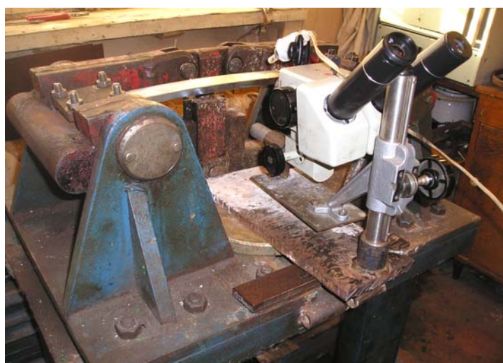
Рисунок 6 - Машина для испытания образцов на малоцикловую коррозионную усталость
