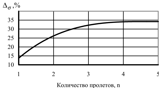
Рис.8. Характер влияния понижения опор на возникающие напряжения в многопролетных балочных системах
