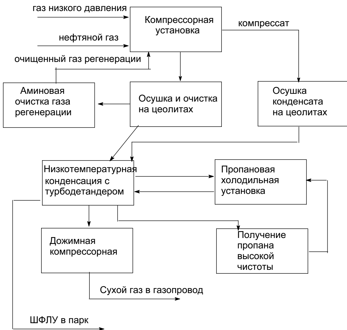
Рис.1. Принципиальная схема переработки газа на Нижневартковском ГПЗ.
