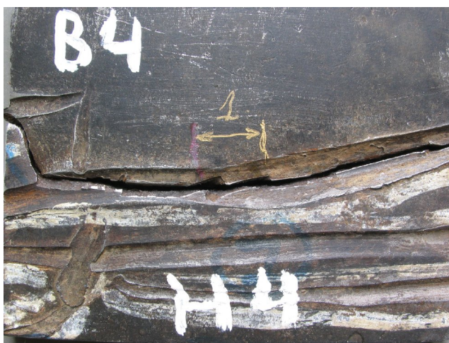
Рисунок 1. Участок аварийного излома со стороны внешней поверхности трубной секции с рисками (разрушение по дну риски)
