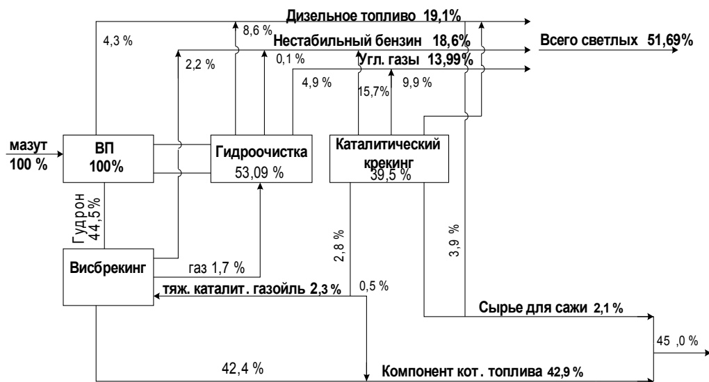
Рис. 2. Блок-схема комбинированной установки КТ-1
